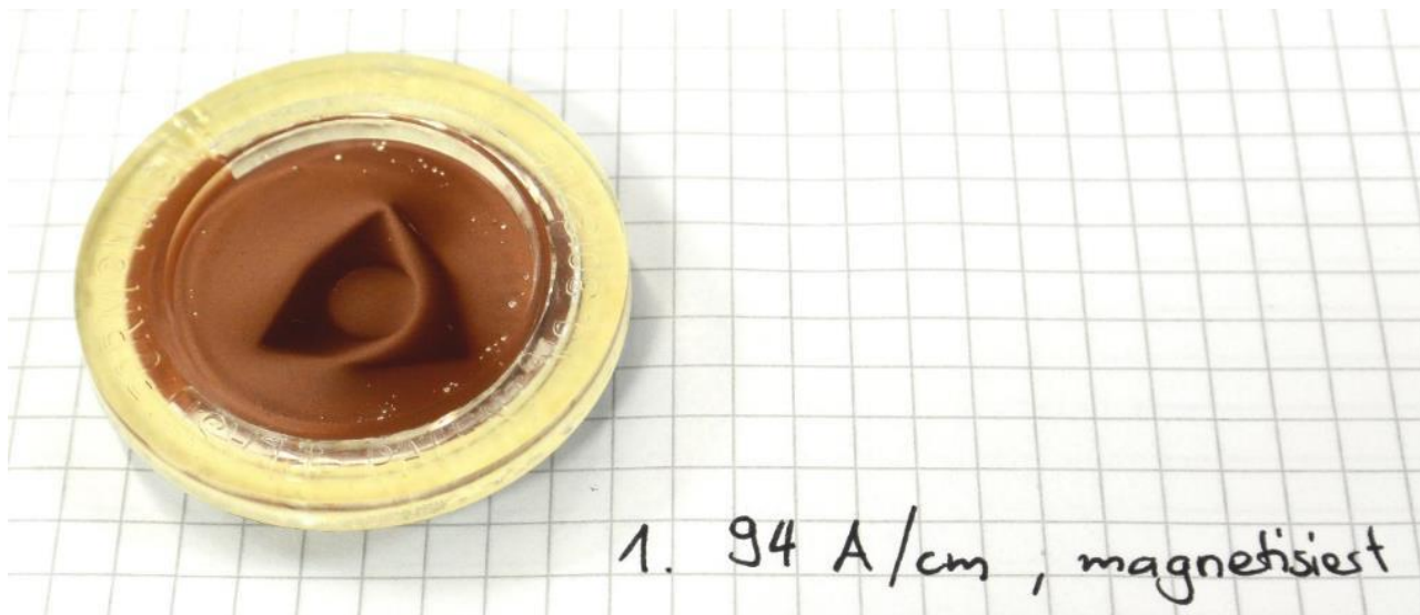
Abbildung 1: Hartmetall Schneideplatte unter Magnetic Viewer
