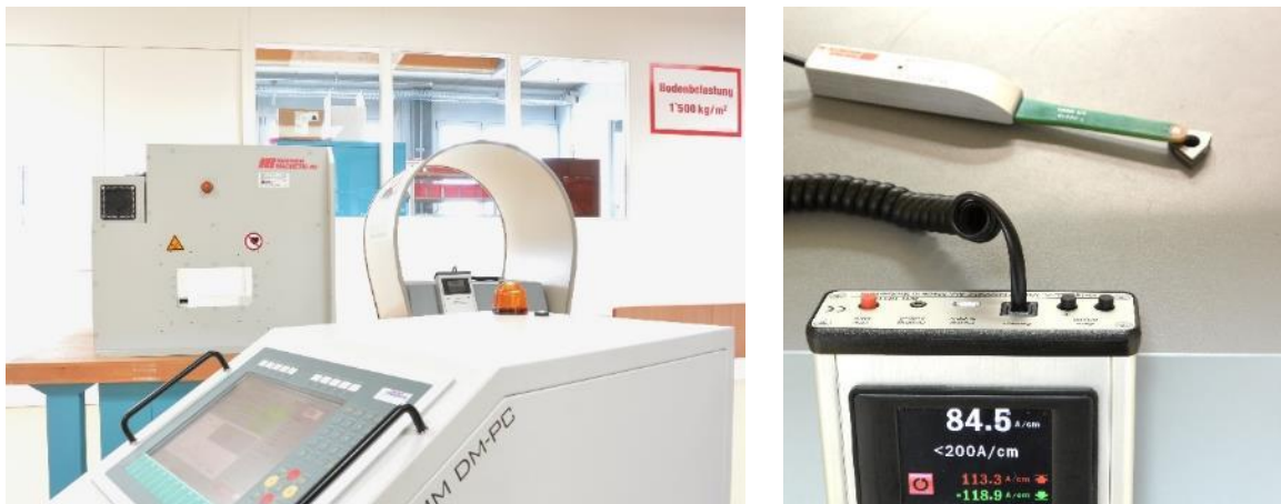
Abbildung 4: Maurer Magnetic VE-2 Spulenmodul mit 260kA/m und DM-P Leistungsmodul und Messung mit M-Test LL
